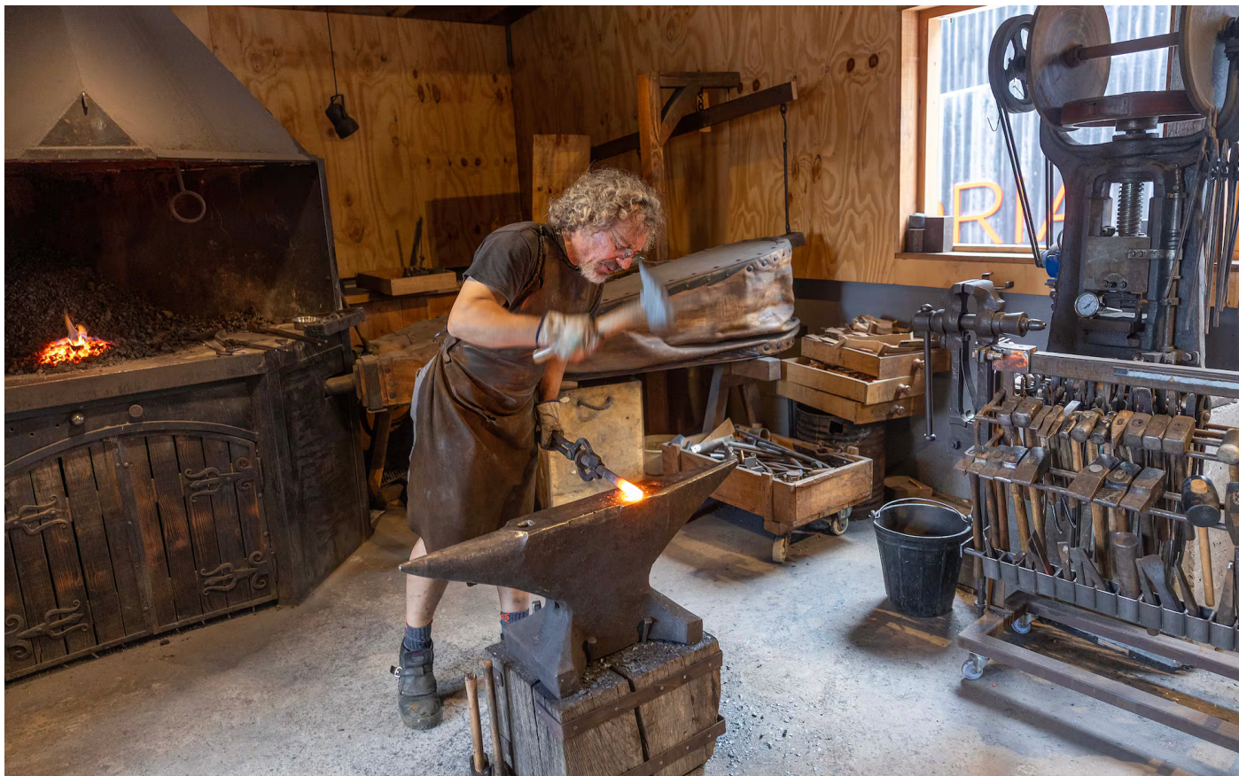
Un herrero fabrica los pernos para la embarcación 'San Juan', un galeón del siglo XVI que se construye en Pasaia. JAVIER HERNÁNDEZ
